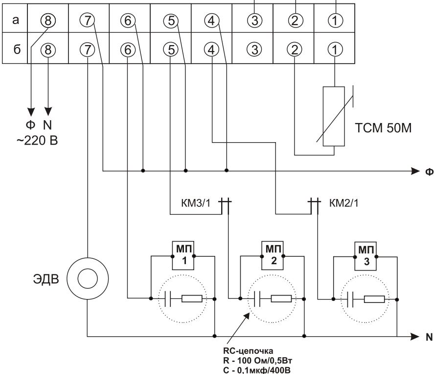
ЭДВ - однофазный электродвигатель (вытяжной вентилятор) от 10 до 100 Вт. Включается при превышении заданного значения влажности в камере.
